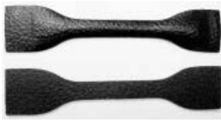
図5 PVC表皮(上)とTPU表皮(下)の比較 (キセノン耐光300MJ 経過後の外観)
